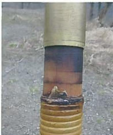
接着剤のものを短くするには、まずガスコングロでジョイント管を熱し、抜きとります
